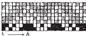
شکل ۵-۱۹- روش پانچ کارت طرح ماشین ژاکارد
