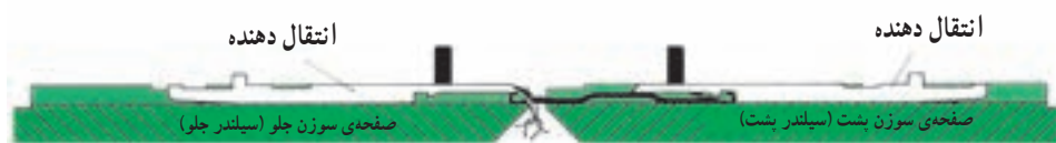
۱- سوزن‌ها توسط انتقال‌دهنده‌ها به سمت صفحه‌ی جلو فشار داده می‌شوند.
