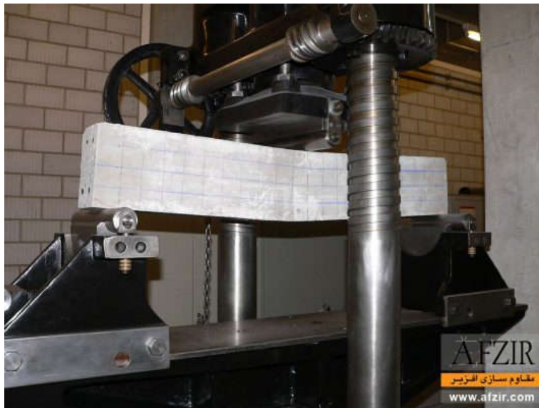
آزمایش خمش برای تعیین مقاومت کششی بتن
